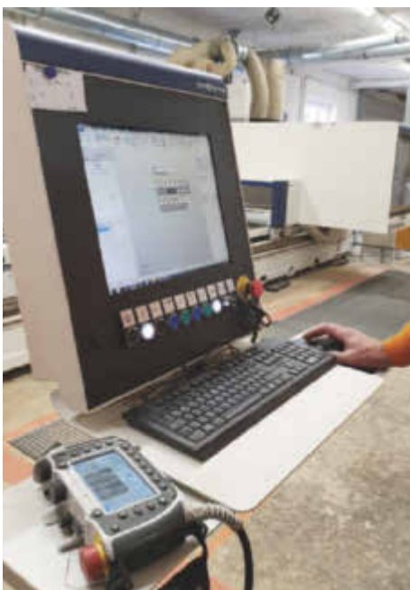
/ Die Tischlerei verfügt über einen hochmodernen Maschinenpark. Hier das CNC-Bearbeitungszentrum.
