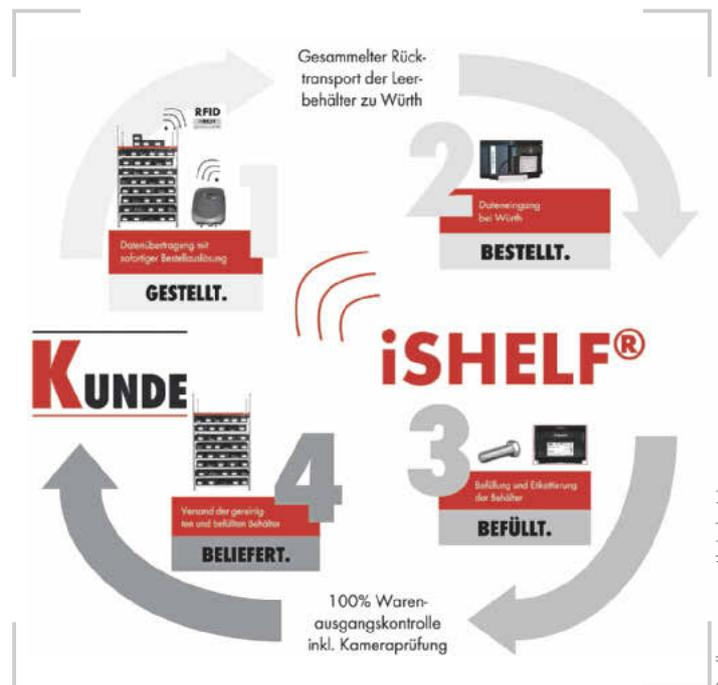
Würth arbeitet auch mit RFID-getaggten Behältern, die das Material zum „Cyber Physical System“ (CPS) in der Welt des Internets machen und damit den Kanban-Kreislauf automatisch schließen.
