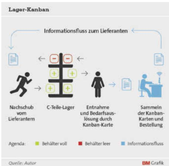
Das Lager- bzw. Lieferanten-Kanban funktioniert nach dem Pull-Prinzip. Das heißt, dass durch die Entnahme aus dem C-Teile-Lager die Bestellung beim Lieferanten ausgelöst wird.
