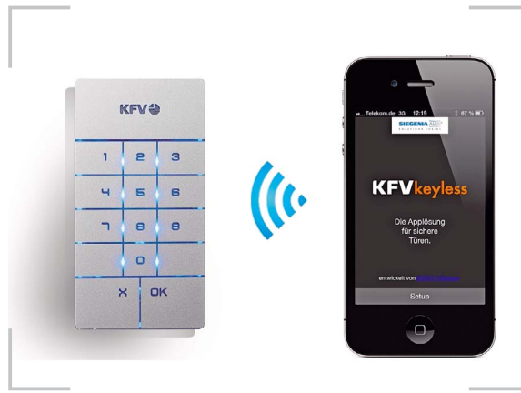
/ Das KfV Keyless-System öffnet die Tür entweder mit einem Zahlencode oder mittels Bluetooth-Schnittstelle per Smartphone. (Fotos: Siegenia-Aubi-Gruppe)
